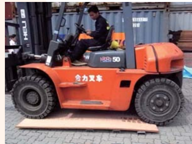
倉庫同事在收貨時根據進貨品質控制程式的要求進行8噸叉車模擬承載測試
