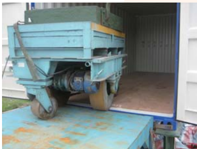
栢堅的集裝箱地板在接受7,260承載力測試
