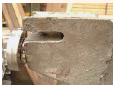
掛衣梁（衣架巴）測試後狀態-左側/右側，槽口和焊縫處並沒有出現斷裂或裂紋。
